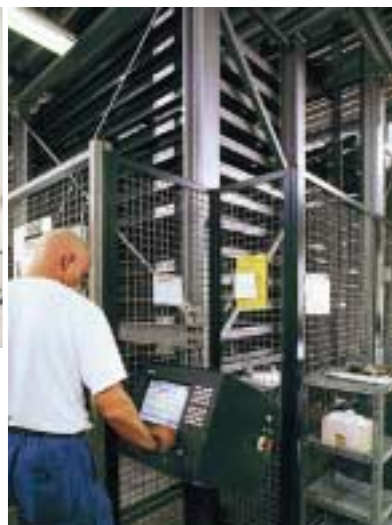
... CNC-Blech-Hochregallager mit einer Traglast von 93 t für Blechsorten von Aluminium bis Zirkonium
