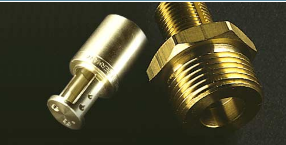
Drehteile mit anschließender Fräsbearbeitung bzw. Kombinationsbearbeitung an einer Maschine
