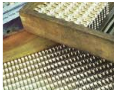
Pfenniggroße Fräsgehäuse für Hörgeräte, die in Brillenbügel integriert werden
